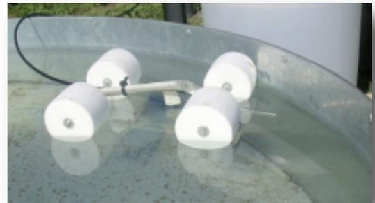
Sensor TS 265 com bóia para tanque de evaporação
