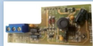
**AS 170** Protetor de choque elétrico unipolar para entradas analógicas e digitais.
