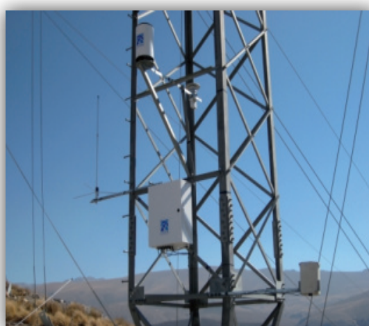
Medição da altura da neve e parâmetros meteorológicos, Minera Alumbreira, Catamarca, Argentina
