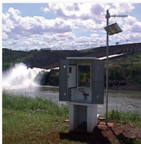
Estación de medición de la Red de Monitoreo Hidrometeorológico de ITAIPU, Brasil-Paraguay
