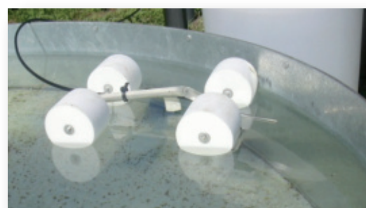
Sensor TS 265 con flotador para tanque de evaporación
