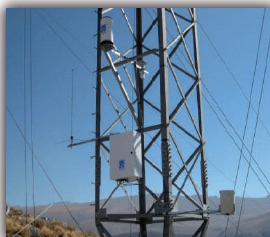
Medición de altura de nieve y parámetros meteorológicos, Minera Alumbra, Catamarca, Argentina
