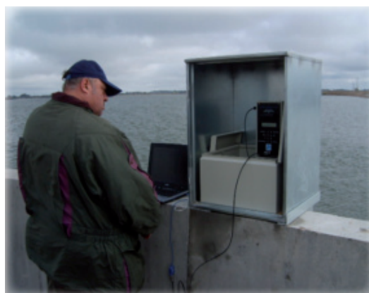
Medición de nivel en Laguna Picasa
