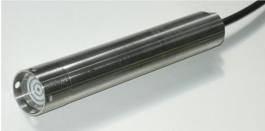
Este sensor sumergible hasta 20 mts. de profundidad permite la medición precisa de la conductividad por medio de electrodos de titanio y acero inoxidable.
