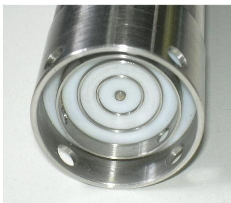
En la foto podemos ver la carcasa y los cuatro anillos concéntricos (electrodos). Una placa acondicionadora demodula las señales capturadas en los electrodo, midiendo solamente la componente fundamental (frecuencia de excitación), estas son cuantificadas y procesadas, luego se realiza la compensación térmica y se genera una salida de corriente 4-20 mA.
