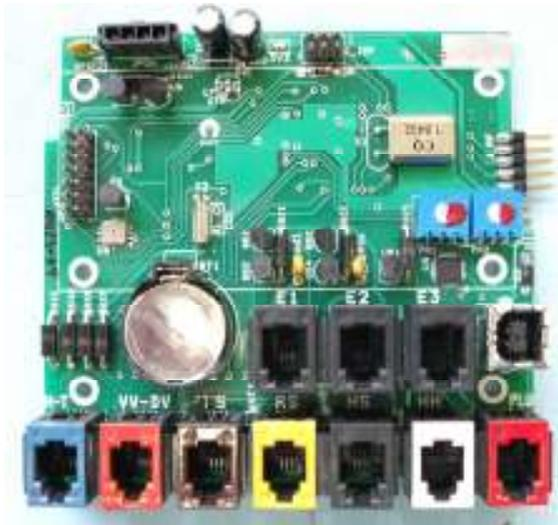
En el circuito electrónico, los conectores RJ11 poseen el color que los identifica para conectarlos correctamente con sus correspondientes sensores.
