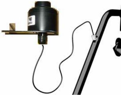
Tome el cable del sensor de radiación solar e introdúzcalo en el orificio que se encuentra en el tubo soporte (mismo tubo de los sensores del viento). Luego deslice el cable
