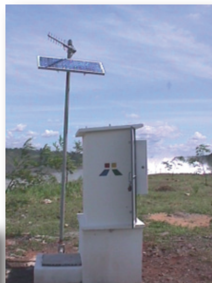
Estación de medición de la Red de Monitoreo Hidrometeorológico de ITAIPU, Brasil-Paraguay
