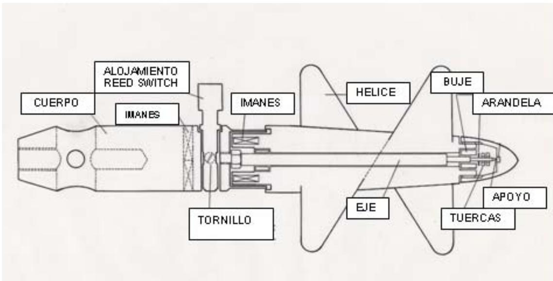
Para realizar el cambio de la HELICE o su limpieza sostener el cuerpo y mantener la hélice fija a fin de poder girar el cono en sentido antihorario, hasta retirarlo completamente. Luego con dos llaves fijas de 5,5mm mantenga fija la tuerca mas cercana a la hélice y desatornille la mas alejada. Retirar las dos tuercas, la arandela y la hélice ya queda libre. Limpie con agua (no use aceite!) el interior de la hélice, los bujes y el eje.
